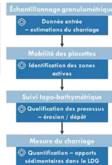
Figure 2 : Protocole de suivi de la mobilité sédimentaire sur le terrain
