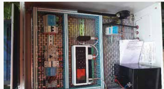
ARMOIRE AVEC ACQUISITEUR SUR LE GAVE DE CAUTERETS
