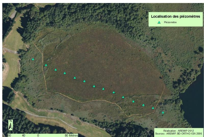
L'interprétation des données récoltées est assez complexe et reste encore à réaliser, mais une première observation peut être faite par comparaison avec les données du programme life : il n'y a pas de différences notables entre les hauteurs de la nappe d'eau entre 1999 et 2012.
