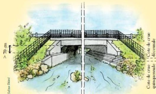
Les banquettes en béton sont tout à fait adaptées à la Loutre et résistent bien à l'usure. Il existe des éléments préfabriqués incluant de telles banquettes.
